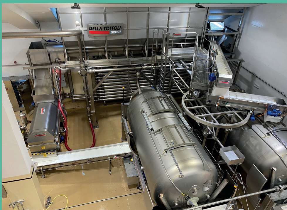
A sinistra: processo di ricezione uve e pressatura in atmosfera inerte
